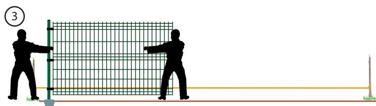
Sul primo palo ( e l'ultimo) - inserire i collari semplici dall'alto del palo. Avvicinare il pannello e successivamente inserire la vite 8x25 con il rispettivo dado. Non lasciare il pannello a bandiera per non compromettere la posa del palo.
