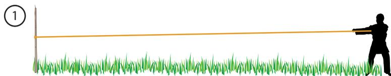
Preparazione del terreno dove si poserà la recinzione in pannelli. Posare i picchetti e stendere il filo guida per poi installare i paletti perfettamente allineati.
