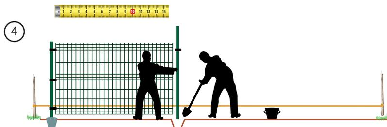
Per realizzare nel terreno il secondo foro, simulare il montaggio dei collari del secondo palo. Per i pali intermedi, avvicinare un semicollare al palo, inserire i pannelli e chiudere con l'altro semicollare fissando il tutto con due bulloni 8x25. Procedere con lo scavo del palo successivo. Cementare e ricontrollare se le distanze dei pali in basso ed in alto sono uguali.
