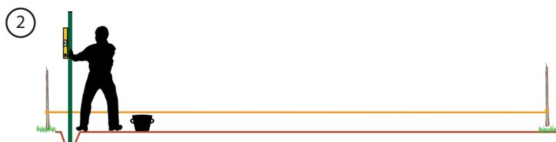
Realizzare nel terreno il foro per la posa del primo paletto. Dotarsi di apposita livella per posare il paletto perfettamente perpendicolare al terreno. Fissare con cemento.
